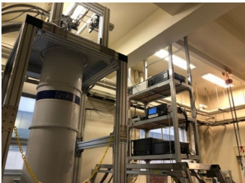
図 5-12 既存無冷媒冷凍機と組み合わせた測定系
