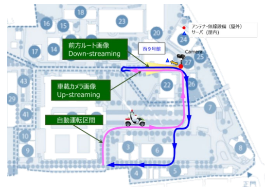
図 5-3 自動運転ならびに動画伝送実験レイアウト
