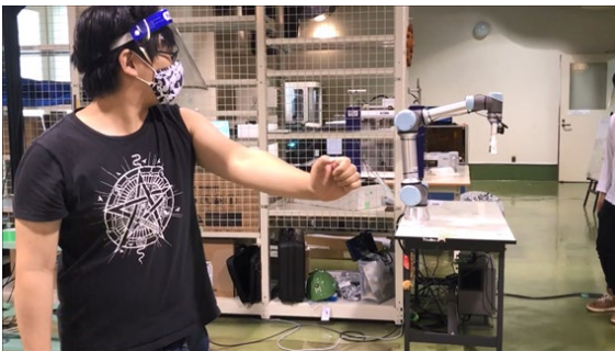
図 4-9 制御用高速モーションキャプチャシステムを 用いた遠隔作業
