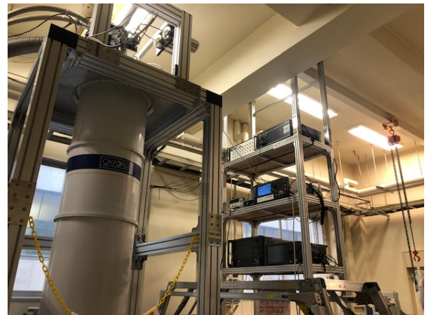
図 4-14 既存無冷媒冷凍機と組み合わせた測定系
