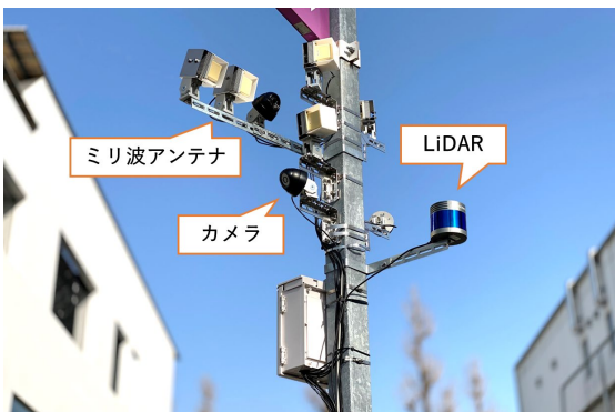
図 4-3 キャンパス内に設置した RSU
