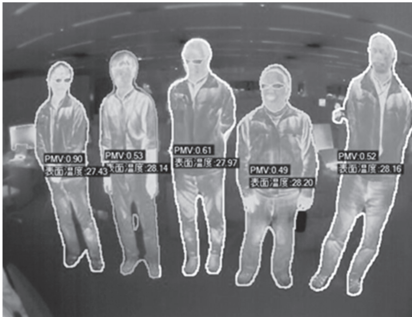
図-2 熱画像を使用した PMV の推定
