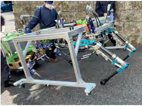
図 4-11 野外フィールド用 4 脚ロボット歩行実験
