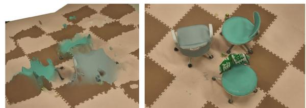
図 4-7 3D 復元モデル (左 : カメラ姿勢制御なし、右 : カメラ姿勢制御あり)
