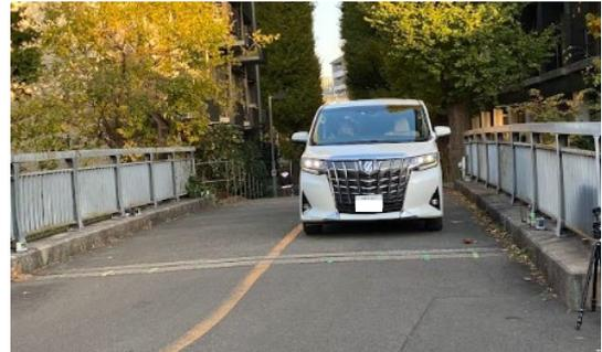
図 4-29 乗用車を用いた載荷試験（轟橋）
