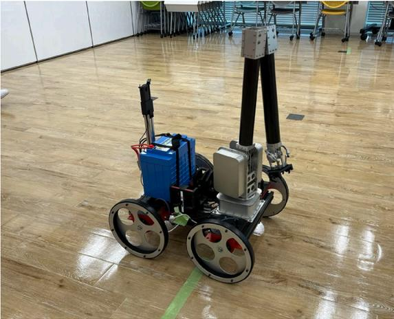
図 4-12 作業移動マニピュレータ RhinoUS-II
