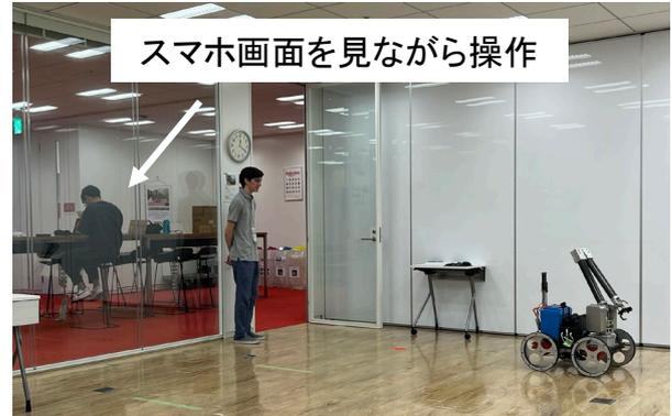
図 4-13 スマートフォンからのロボット遠隔操作
