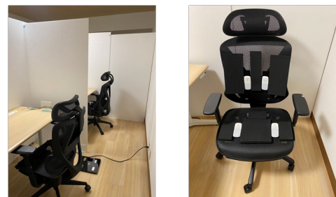
図 4-22 ペルチェ素子を用いた椅子による温冷刺激実験
