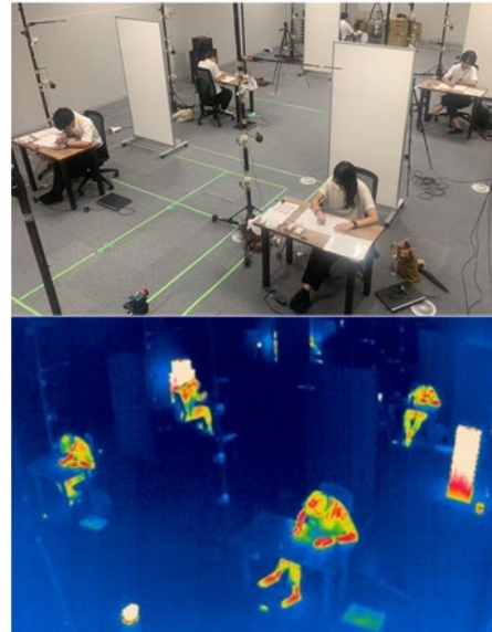
図 4-19 温熱快適性判定システムを用いた被験者実験
