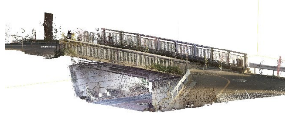
図 4-35 轟橋の点群データ
