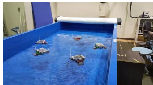
図 4-9 5 台の水上ドローン群の協調制御システム
