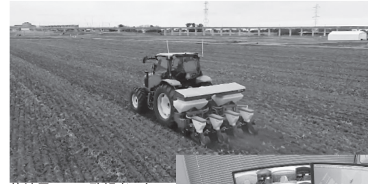
基地局にいる監視者1人で、複数のロボットトラクタを運転できます。 出所：農研機構
