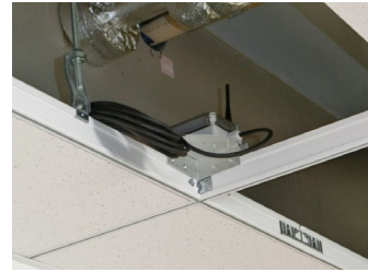
図 4-31 天井(左) および非構造壁(右) の加速度計設置状況
