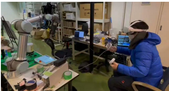
図 4-10 VR ロボット遠隔操作実験の様子
